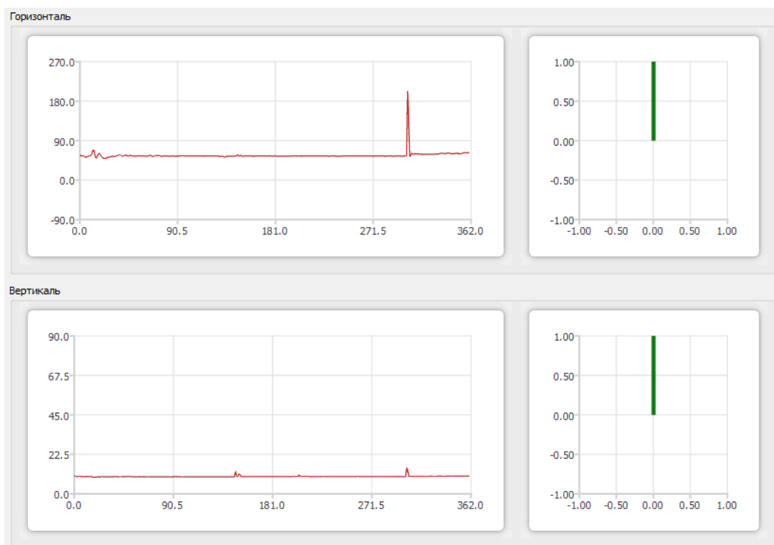
Рисунок 17. Результат работы программы по оценке направлений на источник звука
