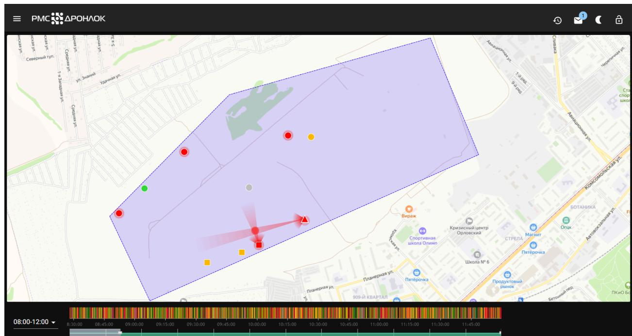
На этом рисунке отражен контролируемый район (сиреневым цветом), и расположенные в нём датчики различного типа. При срабатывании датчика система информирует оператора цвето-звуковой сигнализацией о характере события. При обнаружении БПЛА и получении пеленга на него от двух и более датчиков, система рассчитывает предполагаемые координаты БПЛА и отображает их на карте в виде пульсирующей точки.
